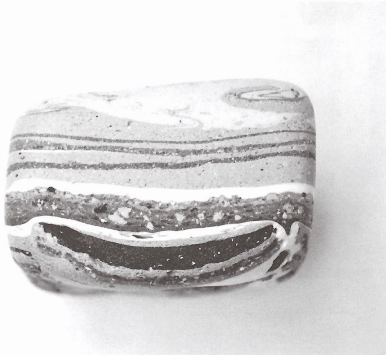
Keramisk fragment. 16. juni 2016. Kunsthøgskolen i Oslo. Et fragment (l: 4,0 cm; b 3,2 cm; h 2,5 cm) saget fra en keramisk tavle og slipt i en kulemølle. I et keramikkverksted brukes kulemøllen blant annet til formaling av grovere glasurråstoffer.
